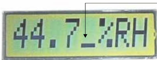
Sul display appare in quarta posizione una barra lampeggiante che sta ad indicare che il datalogger sta campionando
